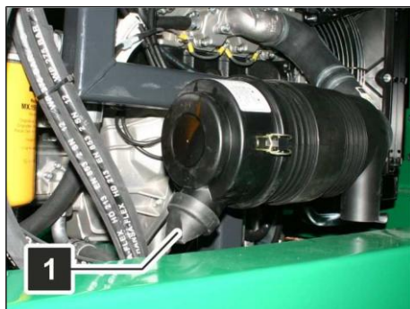
Fig. 46: Filtrul de aer - supapa de praf
