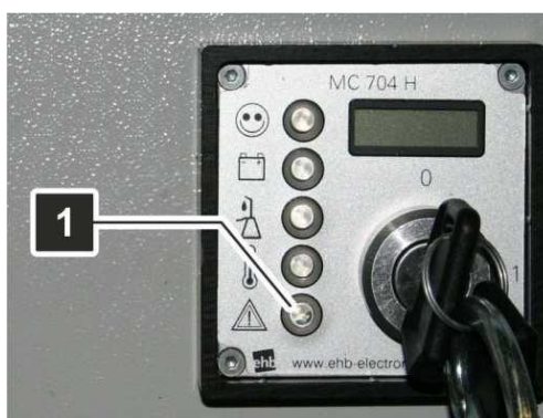
Fig. 49: Modulul de pornire - filtrul de aer- indicatorul de colmatare XE "Filtrul de aer"
