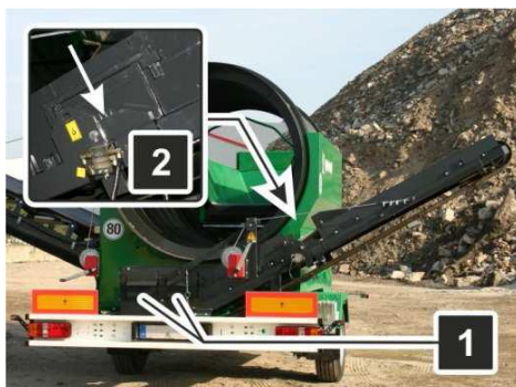
Fig. 33 Banda de evacuare a refuzului de ciur - Montarea pieselor de tablă
