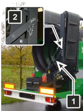
Fig. 27: Supapa de eliberare a frânei de aer comprimat
