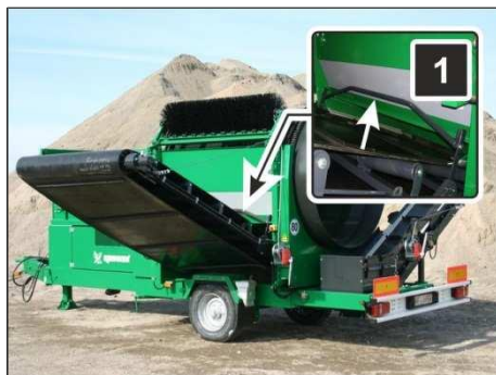
Fig. 31: Banda de evacuare a granulelor fine - Ridicarea mânerului
