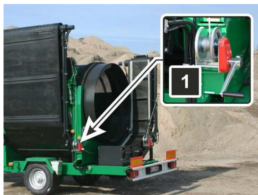
Fig. 19: Banda de evacuare a granulelor fine Ridicarea
