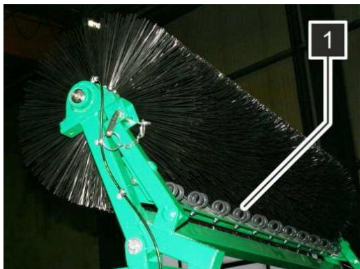
Fig. 11 Raclorul pentru peria cilindrică
