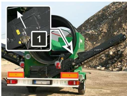
Fig. 21: Banda de evacuare a refuzului de ciur - Demontarea pieselor de tablă
