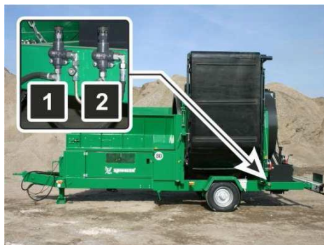
Fig. 37: Poziția Hidraulică a benzilor de evacuare
