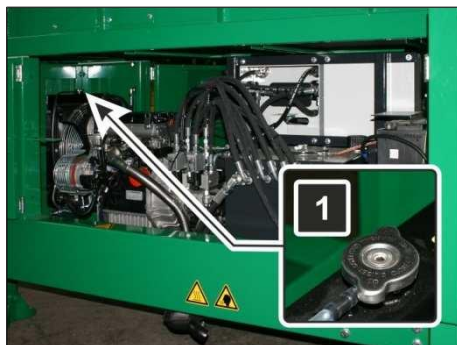
Fig. 43: Motorul - alimentarea cu lichid de răcire
