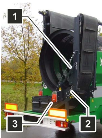
Fig. 32: Banda de evacuare a refuzului de ciur Coborârea
