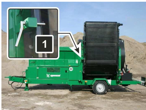
Fig. 20: Banda de evacuare a granulelor fine Asigurarea
