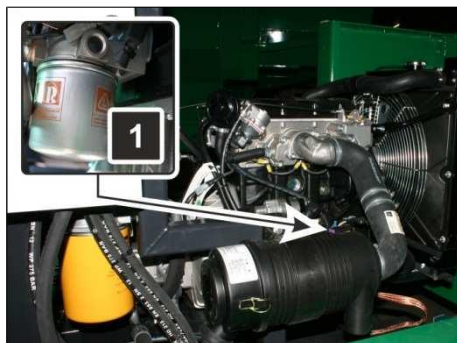
Fig. 45: Motorul - filtrul de motorină
