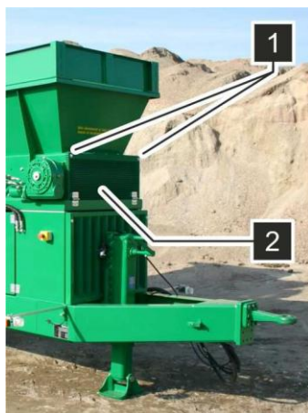
Fig. 39: Banda buncărului, verificarea contaminării
