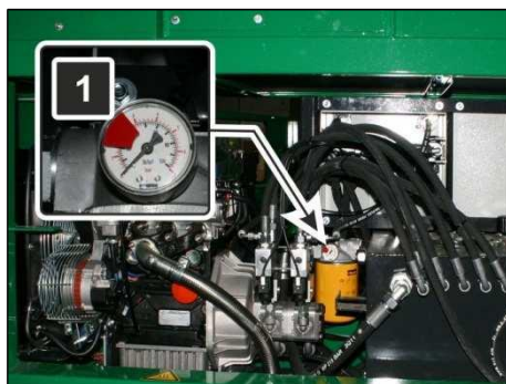
Fig. 47: Instalația hidraulică - indicatorul de întreținere al filtrului de ulei XE "Uleiul hidraulic"
