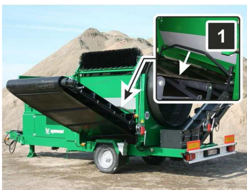
Fig. 18: Banda de evacuare a granulelor fine - rabatarea mânerului.
